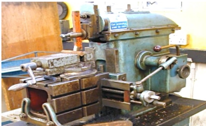
Slika 4: Snimak rada kratkohodne rendisaljke (simulacija)
