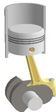
Slika 3: Klipni mehanizam (animacija)
