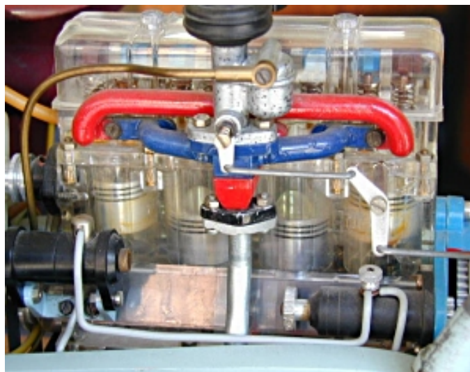
Slika 3: Snimak rada automobilskih klipova (simulacija)
